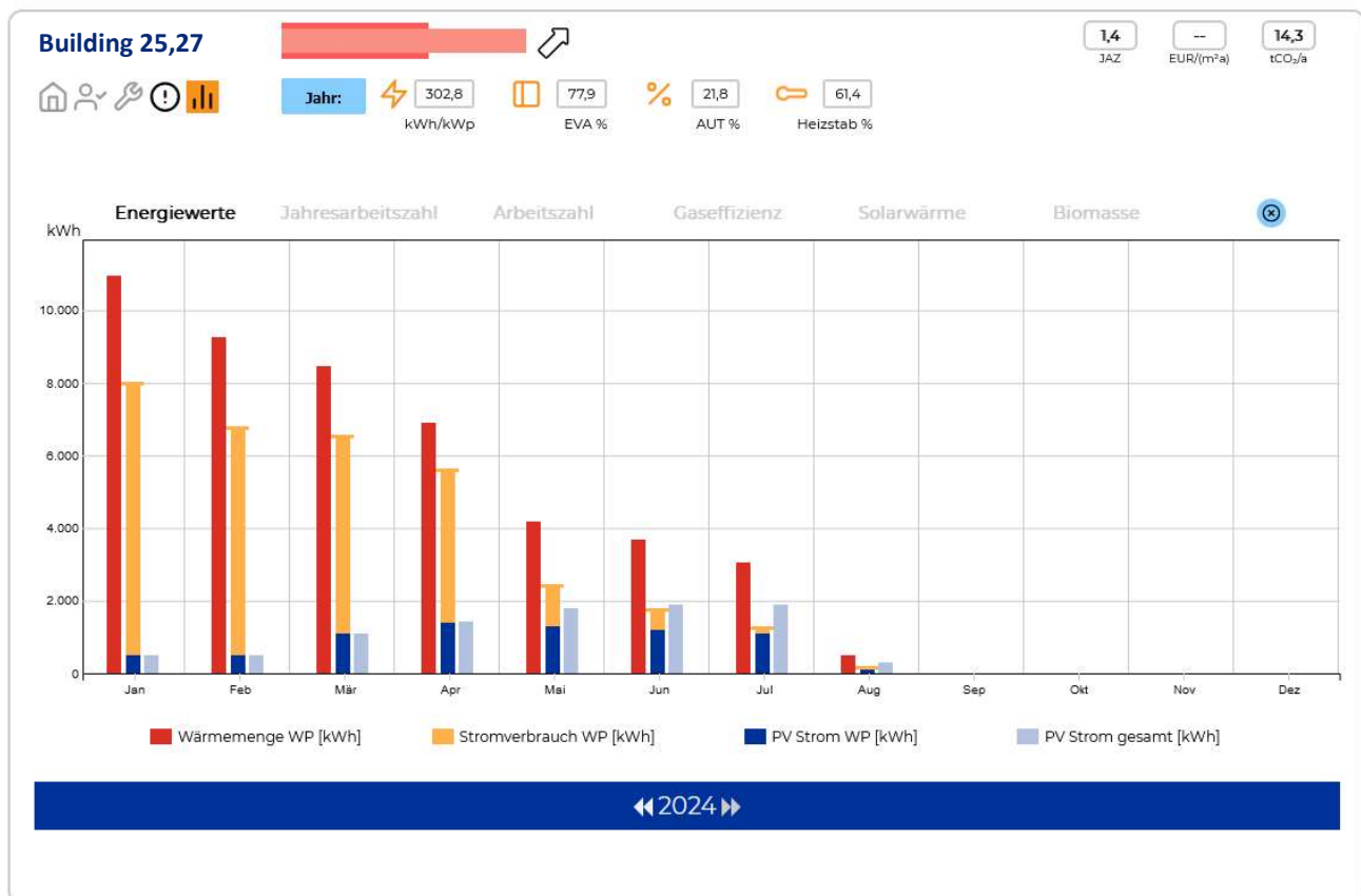
Energiewerte mit Informationen zur Arbeitszahl und Nutzung des PV-Stroms für die Wärmepumpen
