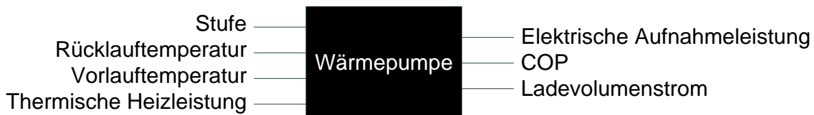
Abbildung 80: Ein- und Ausgänge am Blackbox-Modell der Wärmepumpe
